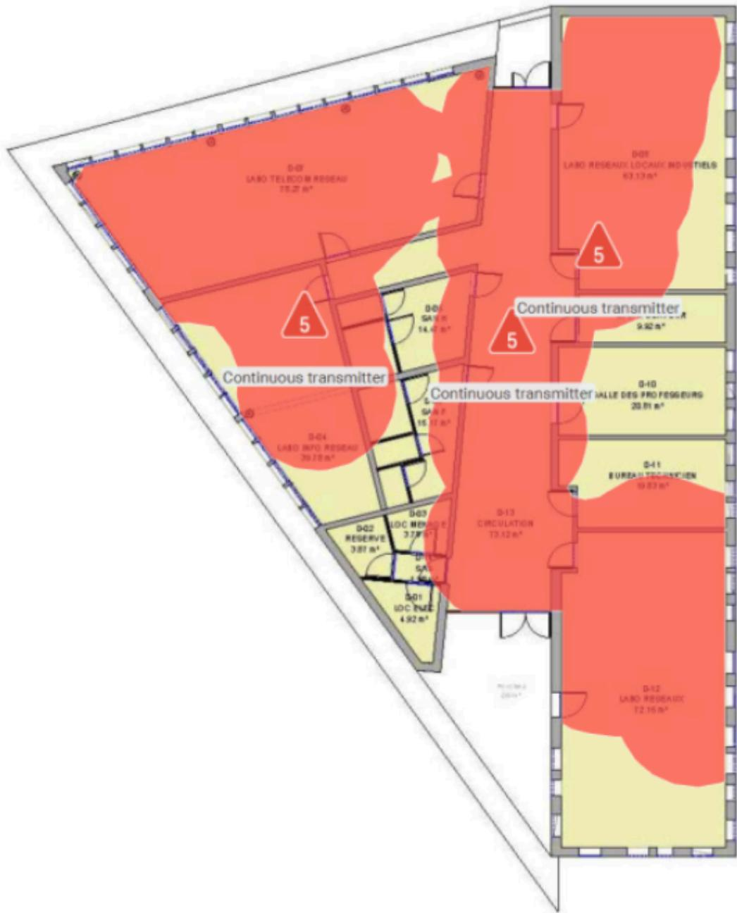
Identification d'un émetteur continu (Continuous Transmitter) saturant la bande de fréquence 5 GHz et causant des pertes de paquets sévères dans la zone centrale.
