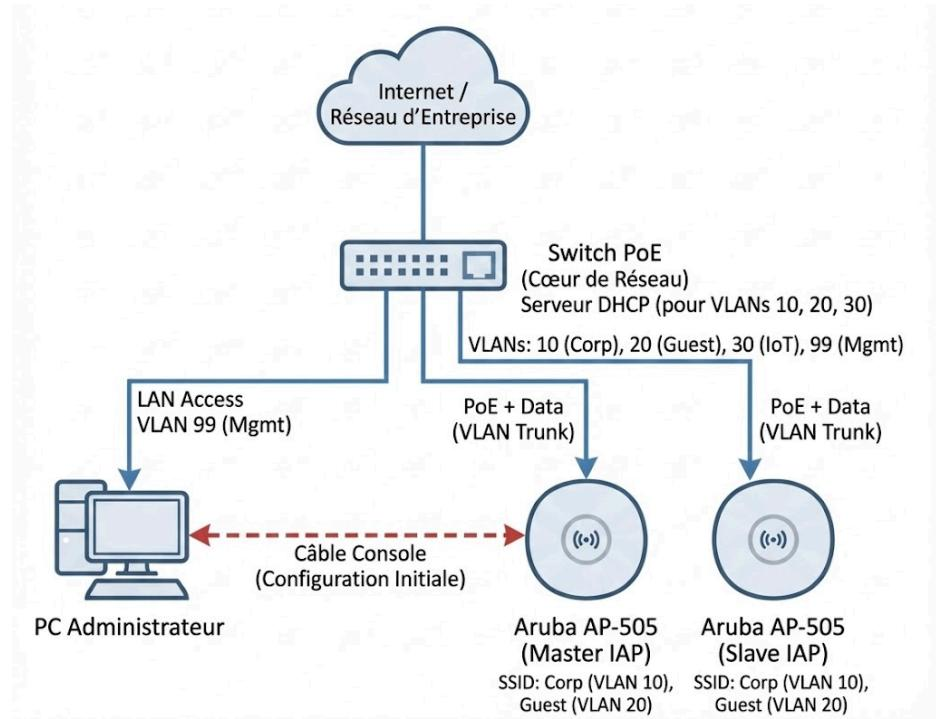
L'architecture repose sur une segmentation stricte via des VLANs (Réseaux Locaux Virtuels).
